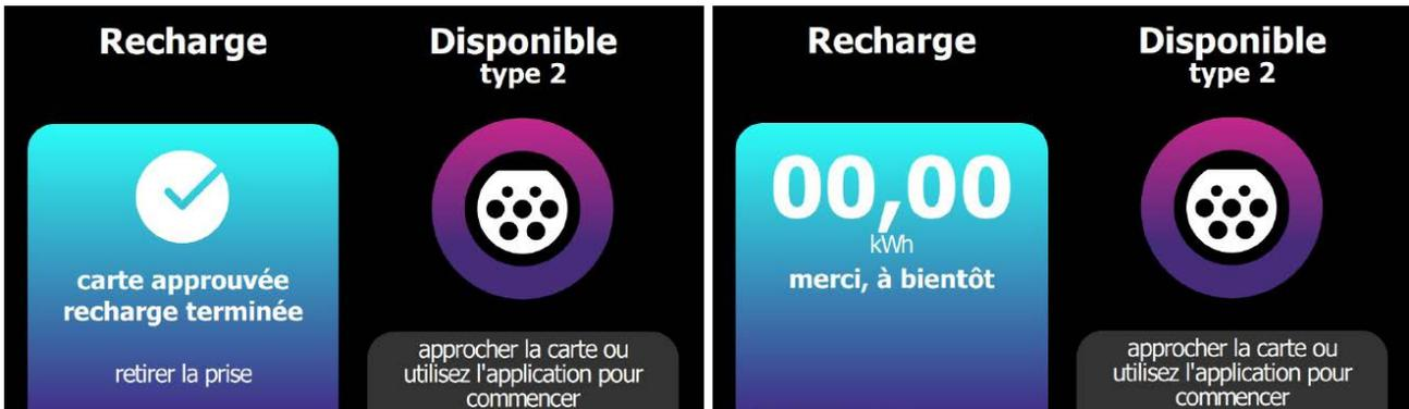
Le système cesse d'injecter le courant du côté correspondant à la carte à puce RFID utilisée et indique les Wh injectés pendant la recharge. À présent, il faut extraire la fiche du côté gauche.
