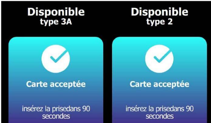
À ce stade, l'utilisateur doit insérer **dans les 90 secondes suivantes** (timeout) la fiche du câble de charge dans la prise choisie.
