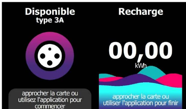
Dès le début de la recharge, sur l'écran (du côté d'insertion de la fiche – par ex. : droit) apparaissent les kWh injectés.
